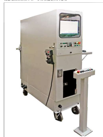
獨立電氣櫃及操作台，多方操控更具人性化
