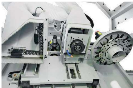
自動換刀系統提供了 10 個工位為標準，可用於 HSK 刀柄
