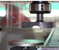
刀長量測裝置 直徑為 100mm.
