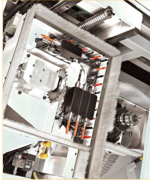
排鑽單元配有 7 X 13 個垂直排鑽和 X 向 3+3，Y 向 1+1 個水平副鑽。
