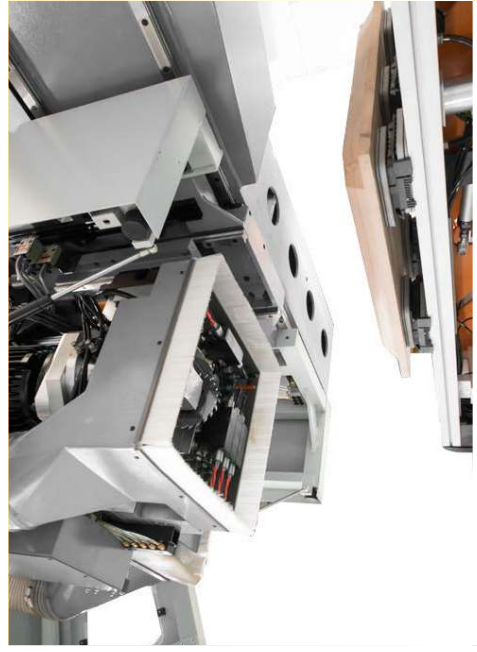
激光指示系統用於自動定位面板鑽和吸盤。操作員可透過對話式操作介面設定定位吸盤和基準桿的相對位置，並自動生成和優化 CNC 程序。
