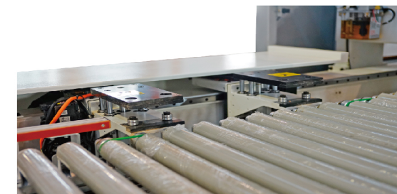
伺服夾爪機構，隨時保持在加工狀態，無須重回原點增加加工時。雙夾爪機構，有效加工板長可達2.4米
