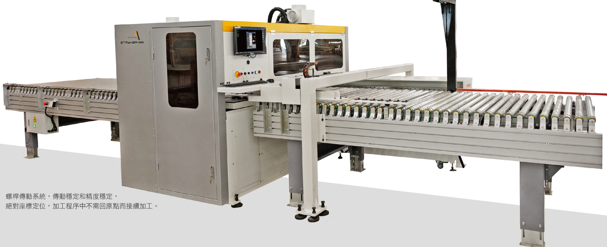
採用氣浮台面設計，減少板材表面的摩擦
